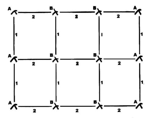
2. Stecken Sie die Dachkonstruktion des Zeltes wie abgebildet zusammen. Bitte beachten Sie hierbei, dass die
