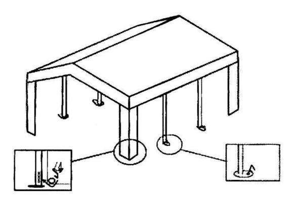
Befestigen Sie die Seiten- und Giebelwände in Kombination mit der Dachplane. Nutzen Sie hierzu die beiliegenden Spanngummis.
