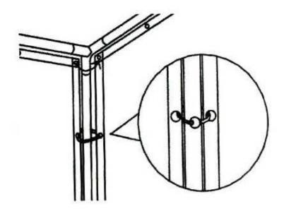
Fixieren nun ebenfalls das Zeltgestänge mit den Abspannseilen. Hierfür binden Sie die Seile an den Eckverbindern (A), führen die Seile durch die Öse an der Dachplane nach außen und befestigen das Seil mit Hilfe der Spiral Erdhaken am Boden.
