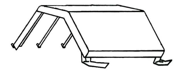
5. Heben Sie das Zelt nun, mit ausreichend Personen, an und fixieren Sie wie bereits in Schritt 3 beschrieben die Standrohre. Sichern Sie nun sofort das Gestänge mit den
